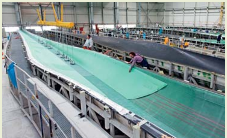
Fig. 14 Rotor blade production Photo: Nordex 2007
