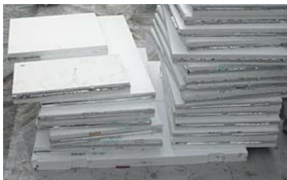
Abb. 13 Für den Baustellenbetrieb hat die Kaschierung der VIP-Elemente Vorteile. Foto: IGEL, Wismar
