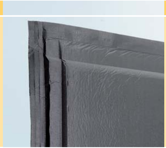
Abb. 27 Dieses VIP ist auf der Außenseite mit einem Schutzgewebe aus Glasfasern kaschiert. Foto: va-Q-tec
