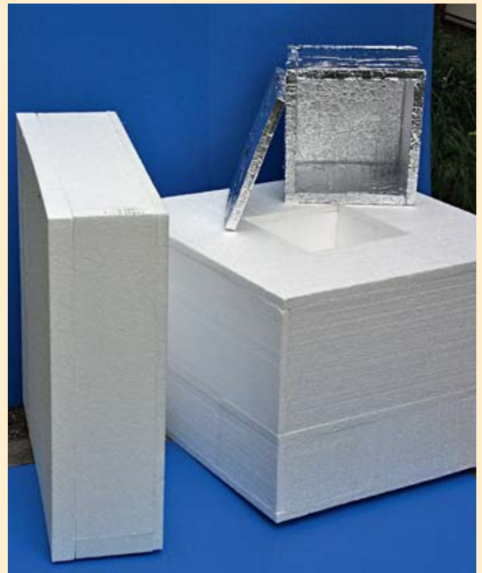
Abb. 5 Etwa 10 Liter umbauter Raum – einmal konventionell gedämmt (weiß), einmal mit gleichwertigen VIP (silbern). Foto: ZAE Bayern
