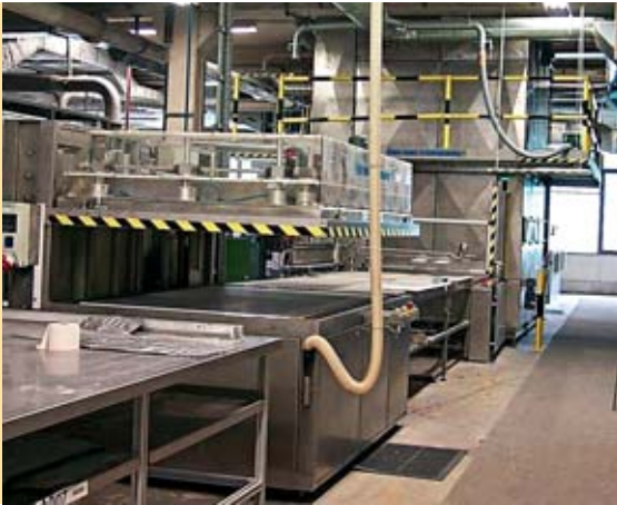
Abb. 9 Halbautomatische VIP-Produktion. Das Gerät in der Bildmitte ist die Vakuumkammer. Foto: the vac company
