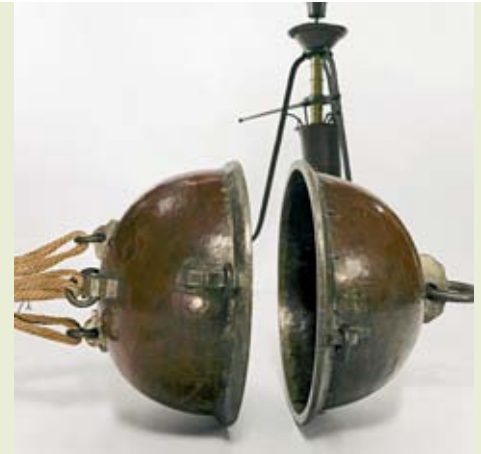
Abb. 10 Im Deutschen Museum in München sind ein Paar der originalen „Magdeburger Halbkugeln“ ausgestellt. Im Hintergrund sieht man auch Guericques Vakuumpumpe dritter Bauart. Foto: Deutsches Museum
