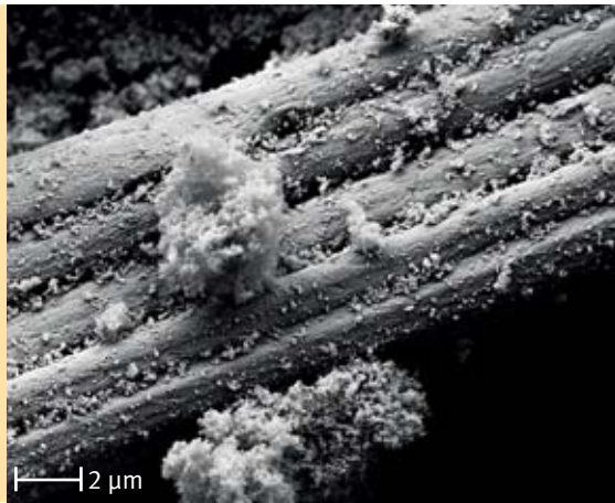
Abb. 6 Der Vergleich zu einer 10 µm dünnen Faser zeigt, wie fein die pyrogene Kieselsäure strukturiert ist. Foto: ZAE Bayern
