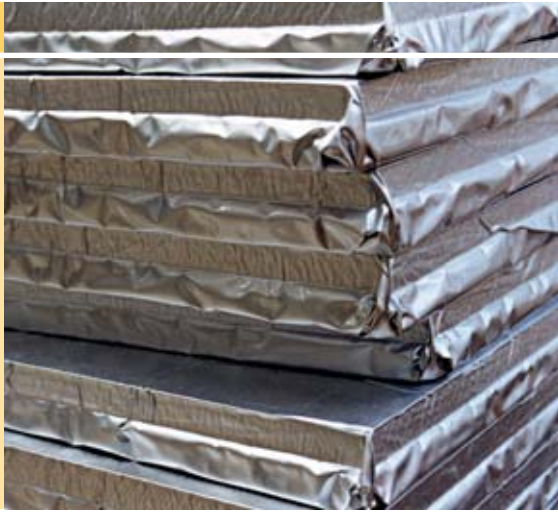
Abb. 26 Weil VIP sehr empfindlich sind, gibt es für ihren Einbau genaue Vorschriften. Foto: Lichtblau Architekten
