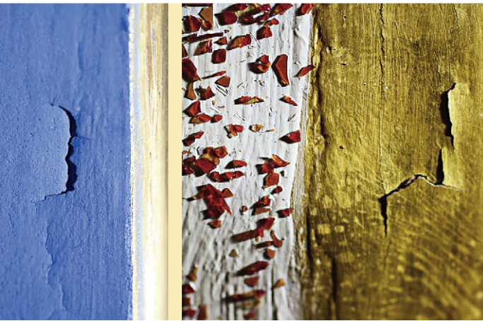
Abb. 12 Klimatisch bedingte Farbablösung an einem restaurierten Altar. Quelle: Fraunhofer IBP / Kristina Holl
