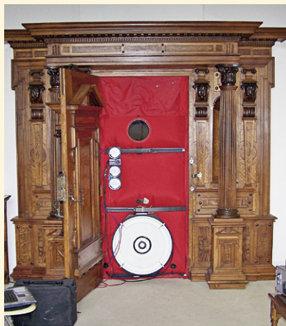
Abb. 6 Ventilator für den Blower-Door-Test Quelle: Volker Huckemann
