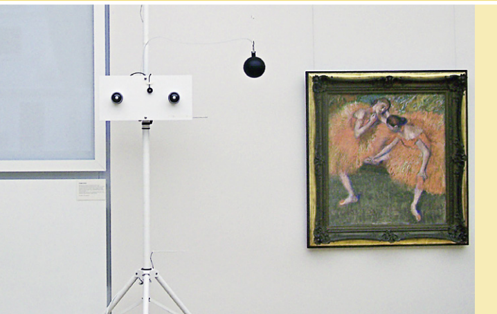
Abb. 31 Albertinum Dresden (nach Sanierung): (links) Aufbau zur Messung von Oberflächen- und Lufttemperatur, Feuchte, Beleuchtung und Strahlung. Quelle: TU Dresden / Ingo Müller; (rechts) Messergebnisse für die Temperaturen (Januar 2011). Quelle: ITG Dresden / Heiko Werdin
